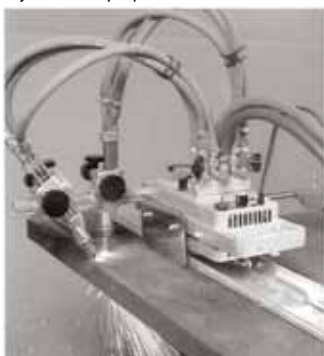
ProFIT с устройством круговой резки для автоматического выполнения круговых резов
