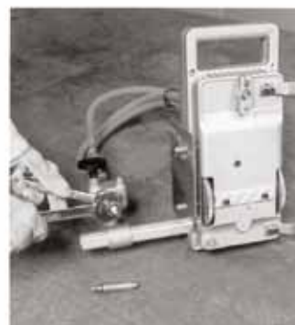
После установки ProFIT на ребро можно легко заменить сопла
