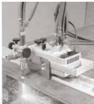
ProFIT для автоматического выполнения прямых разрезов благодаря подаче по направляющей дорожке
