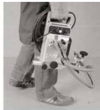
ProFIT удобен при переноске благодаря легкосплавному корпусу
