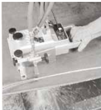
ProFIT для выполнения любых контурных резов благодаря ручной подаче
