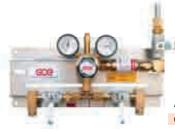
Версия ручного переключающего манифольда ММ70-2 для работы с ацетиленовыми баллонами. Разработана и произведена в соответствии с положениями ISO 14 114. На каждой стороне на входе вверх по потоку от регулятора используются ручные быстродействующие отсечные вентильы. Данные устройства прошли испытания в соответствии с положениями ISO 15 615. В состав входит предохранительный затвор GVA 90 (EN 730-1, ISO 5175), расположенный вниз по потоку от регулятора, а также выпускной шаровой вентиль.
