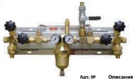
Ручной переключающий манифольд с регуляторами MR6O или MR400 для систем с высокой пропускной способностью различных газов с давлением на входе до 3ООбар. На обеих сторонах входа находится х-образный блок с обратными вентильами и фильтрами, продувочными вентильами и вторыми локальными входными патрубками для расширительных блоков. Отсечные вентильы, регулятор с вентильом сброса давления и выпускным шаровым вентильом, а также другие компоненты смонтированы на щите из нержавеющей стали.
