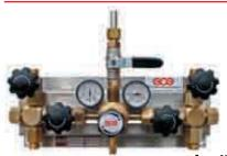
Ручной переключающий манифольд для различных газов с входным давлением до 300 бар. С обеих сторон на входе находится х-образный блок с обратными вентильами и фильтрами, продувочными вентильами и вторыми локальными входными патрубками для расширительных блоков. Отсечные вентильы, регулятор с вентильом сброса давления и выпускным шаровым вентильом, а также другие компоненты смонтированы на щите из нержавеющей стали.
