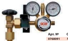
Базовый аппарат с одним входом и одним выходом, отсечным вентильом и регулятором давления, с входным фильтром и обратным вентильом. Предназначен для систем малого или среднего расхода газа и рассчитан на работу с одним баллоном или баллонной связкой.
